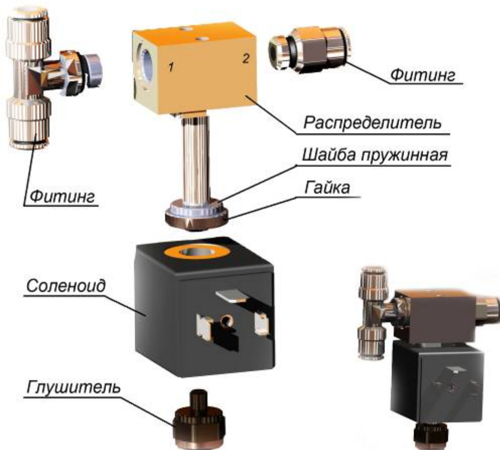
Рисунок 2. Схема сборки электромагнитного клапана.
